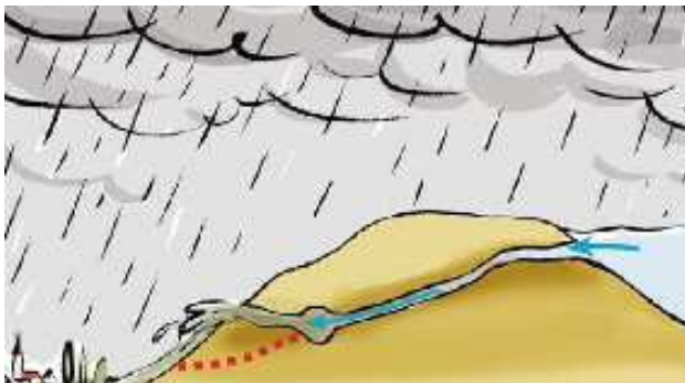
Phénomène d'érosion interne ou renard hydraulique
